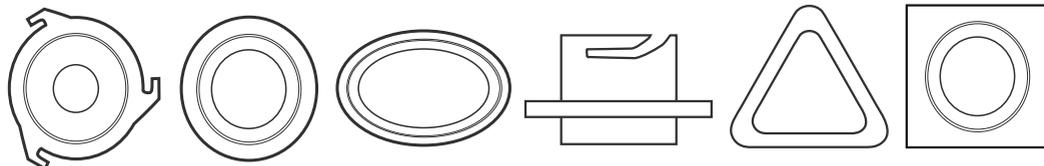
ТИП КРЕПЛЕНИЯ НИЖНЕЙ КРЫШКИ:  ОТКРЫТАЯ  ПОД ШПИЛЬКУ  ЗАКРЫТАЯ
